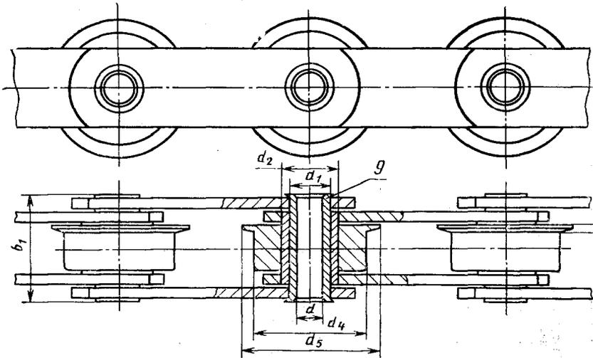
1—валик; 2—втулка; 3—каток с реброй; 4—внутренняя пластина; 5—наружная пластина; 6—ригель; 7—болт; 8—шайба; 9—полый валик.
