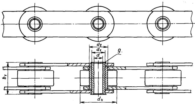
1—валик; 2—втулка; 3—каток; 4—внутренняя пластина; 5—наружная пластина; 6—ригель; 7—болт; 8—шайба; 9—полый валик.
