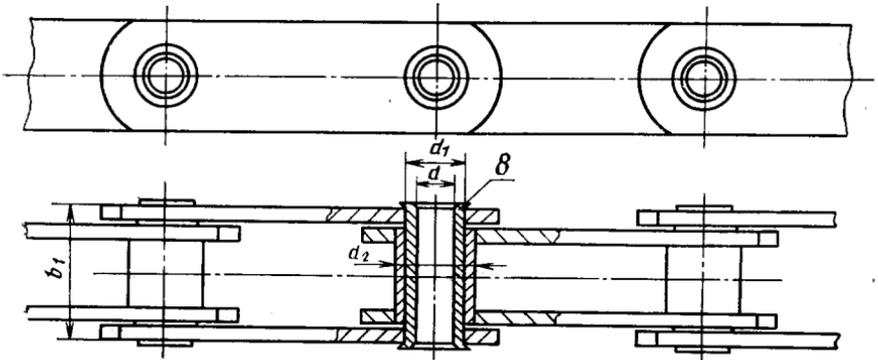
1—валик; 2—втулка; 3—внутренняя пластина; 4—наружная пластина; 5—ригель; 6—болт; 7—шайба; 8—полый валик.
